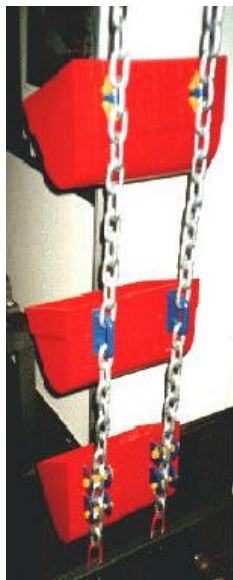
Fig. 42 - Fixação de canecas em EC de corrente
