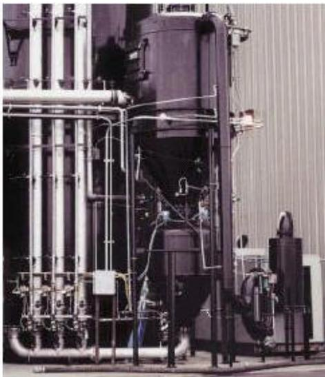
Fig. 71 - Sistema de vácuo de alta velocidade transportando negro de fumo
