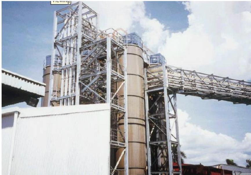
Fig. 69 - Sistema de transporte pneumático para negro de fumo
