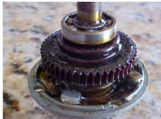
Detalhe da Engrenagem Helicoidal
