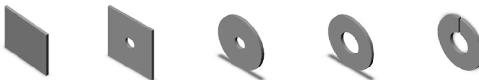
Figura 26 – Fases da fabricação dos discos.
